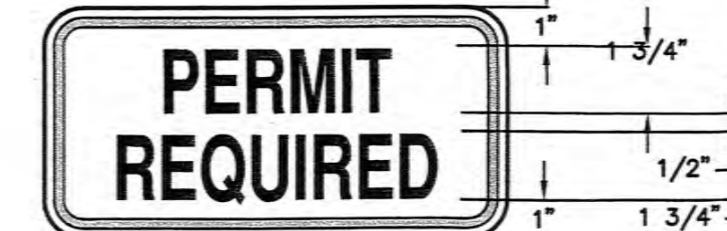
DETAIL-'HANDICAPPED SPACE' SIGN N.T.S.
