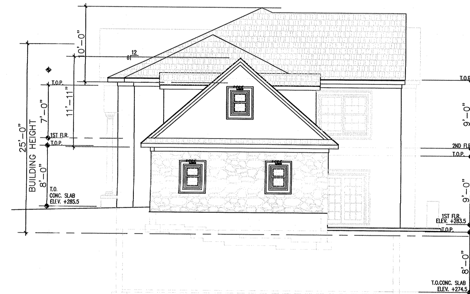
RIGHT ELEVATION SCALE: 1/8" = 1'-0"
