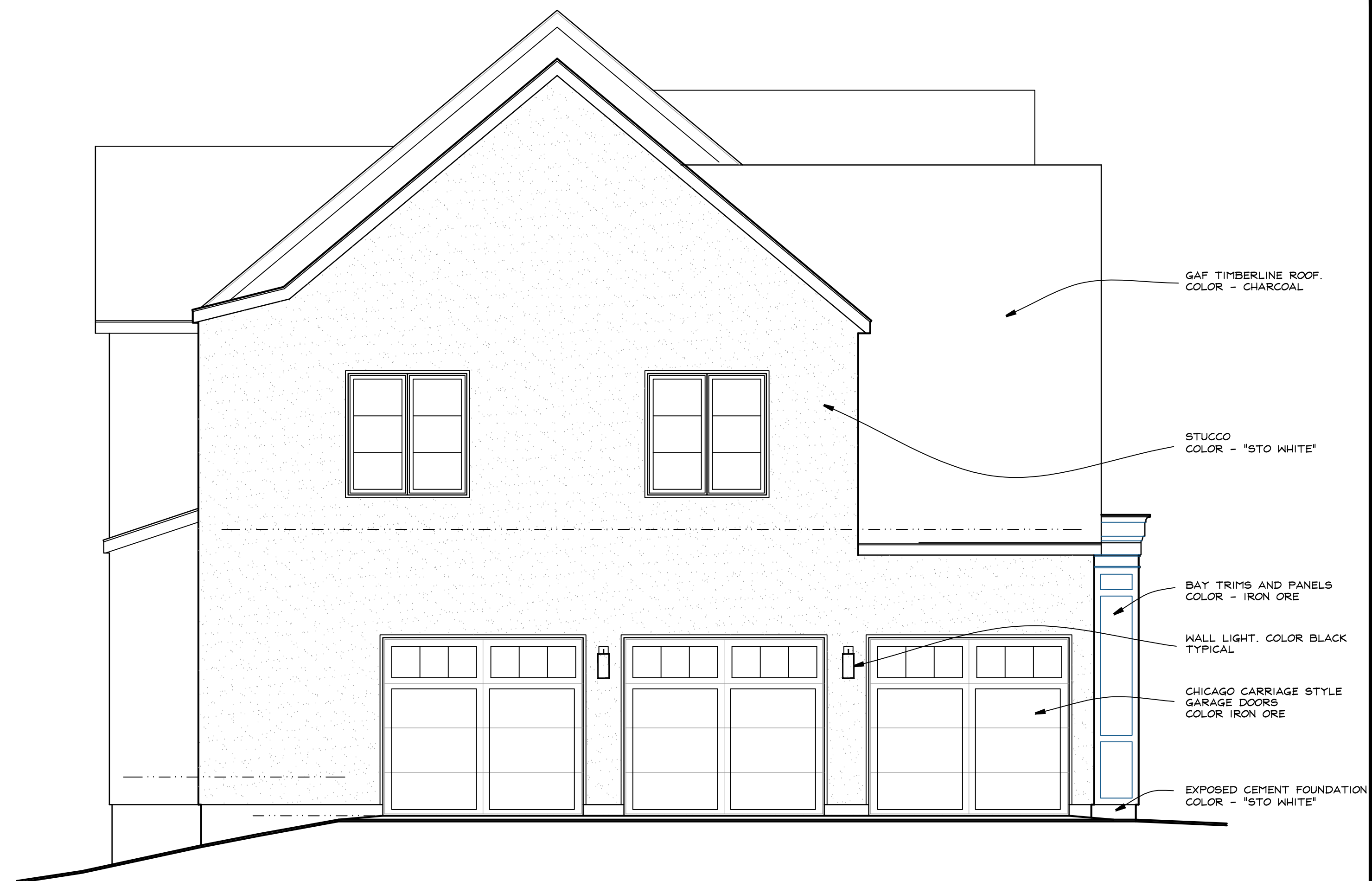
(D) NORTH SIDE ELEVATION A5 1/4" = 1 FOOT
